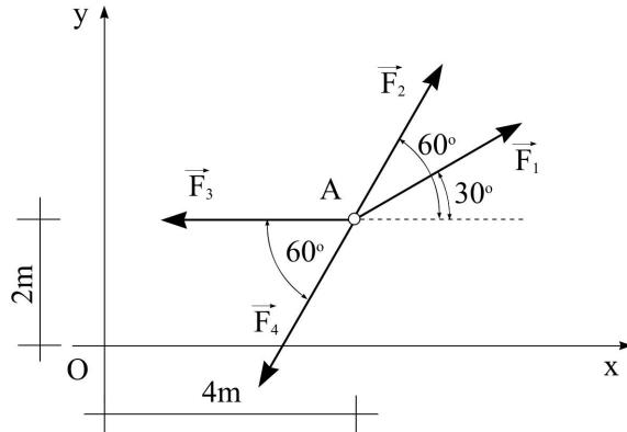
Ako se jedan sistem sila koji deluje na slobodno telo može zameniti drugim sistemom sila ne remeteći pri tom njegovu ravnotežu, odnosno ne menjajući njegovo kretanje, takva dva sistema sila su ekvivalentna. Dati sistem sila  $\vec{F}_1, \vec{F}_2, \vec{F}_3, \vec{F}_4$  i sistem sila  $\vec{F}_5, \vec{F}_6$  su ekvivalentni, što znači da su im rezultante iste:
