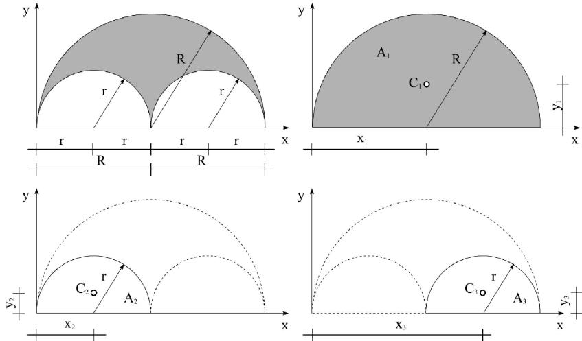
Složena površina ima jednu osu simetrije, koja je paralelna sa y osom i nalazi se na rastojanju  $x = R$  od nje. Težište se nalazi na osi simetrije pa je potrebno odrediti samo koordinatu  $y_C$  težišta. Površine i koordinate težišta pojedinih delova složene površine su:
