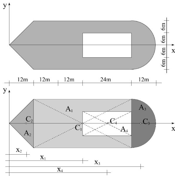
Površina je simetrična u odnosu na x osu pa se težište nalazi na toj osi ( $y_C=0$ ). Treba izračunati udaljenje težišta od ose y. Površine i koordinate težišta pojedinih delova složene površi su:
