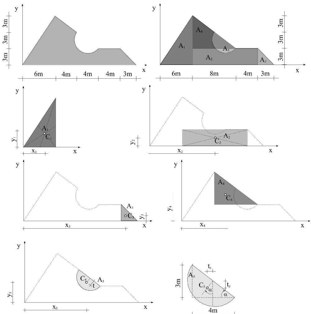
Data složena površina je podeljena na pet delova i to: trougao površine  $A_1$ , pravougaonik površine  $A_2$ , trougao površine  $A_3$ , trougao površine  $A_4$  i polovina kružne površine  $A_5$ , čiji je prečnik  $D = \sqrt{3^2 + 4^2} = 5 \text{ m}$ , pod uglom  $\alpha$  u odnosu na horizontalu, kao što je na slici prikazano. Koordinate težišta pojedinih delova i njihove površine su:
