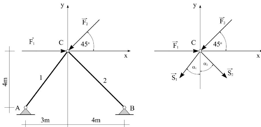
U tački C deluju četiri sile: aktivne sile  $F_1$  i  $F_2$  i unutrašnje sile u štapovima AC i BC, koje će biti obeležene kao  $S_1$  i  $S_2$ .
