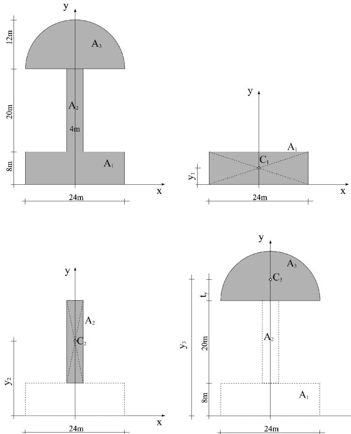
Data površina je simetrična u odnosu na y osu. Težište se nalazi na osi simetrije što znači da je  $x_C=0$ , dok udaljenje težišta od x ose treba izračunati.
