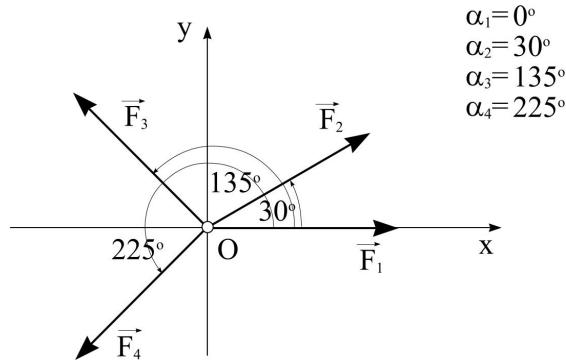
Projekcija vektora sile na osu jednaka je proizvodu intenziteta vektora sile i kosinusa ugla  $\alpha$  koji napadna linija vektora sile zaklapa sa pozitivnim smerom ose. Znak projekcije određen je znakom kosinusa ugla koji vektor sile zaklapa sa pozitivnim smerom ose na koju se vrši projektovanje. Analitički izrazi projekciju vektora sile na ose Dekartovog pravouglog koordinatnog sistema xOy su:
