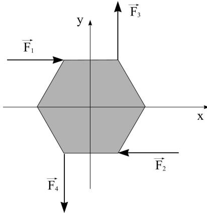
Sile  $F_1$  i  $F_2$  su istog intenziteta, suprotnog smera, paralelnih napadnih linija, pa čine spreg sila, čiji je moment:
