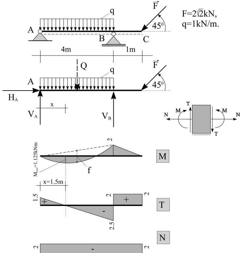
Na gredu sa prepustom, dimenzija i oslanjanja kao na slici, deluju koncentrisana sila u preseku C i raspodeljeno opterećenje čija je rezultanta:
