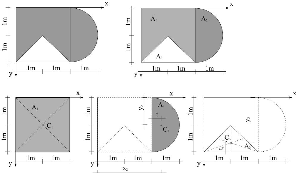
Položaj težišta se primenom analitičkog postupka određuje tako što se data složena površina podeli na više površina za koje se položaj težišta može lako odrediti. Zatim se izračunaju površine pojedinih delova  $A_i$  i odrede koordinate težišta pojedinih delova  $x_i$  i  $y_i$  u odnosu na usvojen koordinatni sistem. Sile kojima se prikazuju osnovne površine postave se u položaj paralelan sa osom Oy i primeni se Varinjonova teorema u odnosu na koordinatni početak:
