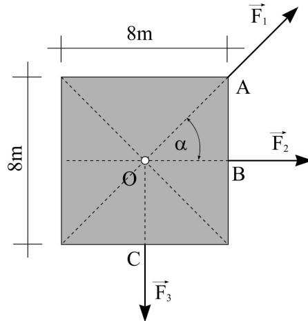
Na kvadratnu ploču deluje sistem sila čije se napadne linije sekut u tački O. Datom sistemu, koga čine sile  $F_1$ , pod uglom  $\alpha_1=45^\circ$ , sila  $F_2$ , pod uglom  $\alpha_2=0^\circ$  i sila  $F_3$  pod uglom  $\alpha_3=270^\circ$  u odnosu na osu Ox, , treba pridodati silu  $F_4$  pod uglom  $\alpha_4$  i primeniti analitičke uslove ravnoteže sistema sila u ravni čije se napadne linije sekut u jednoj tački:
