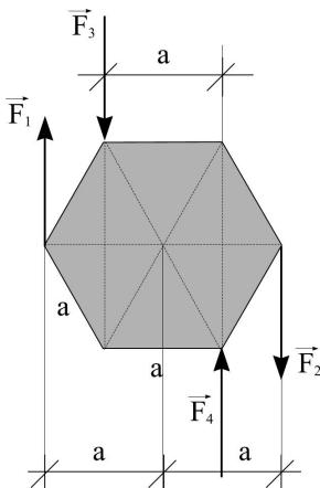
Sile  $F_1$  i  $F_2$  su istog intenziteta, suprotnog smera, paralelnih napadnih linija, pa čine spreg sila, čiji je moment:
