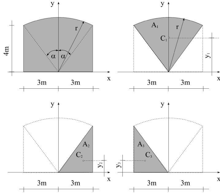
Data površina je simetrična u odnosu na y osu pa se težište nalazi na toj osi. Treba izračunati udaljenje težišta od ose x.
