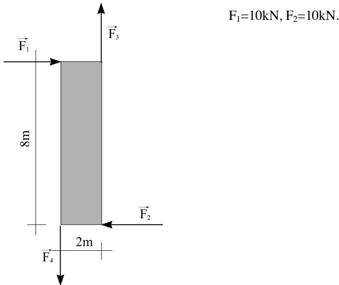
Sile  $F_1$  i  $F_2$  su istog intenziteta, suprotnog smera, paralelnih napadnih linija, pa čine spreg sila, čiji je moment  $m_1$ . Sile  $F_3$  i  $F_4$  su takođe suprotnog smera, deluju duž paralelnih napadnih linija, što znači da i one moraju da budu istih intenziteta i da čine spreg sila, čiji moment  $m_2$  treba da bude jednak momentu  $m_1$ , da bi telo bilo u ravnoteži.
