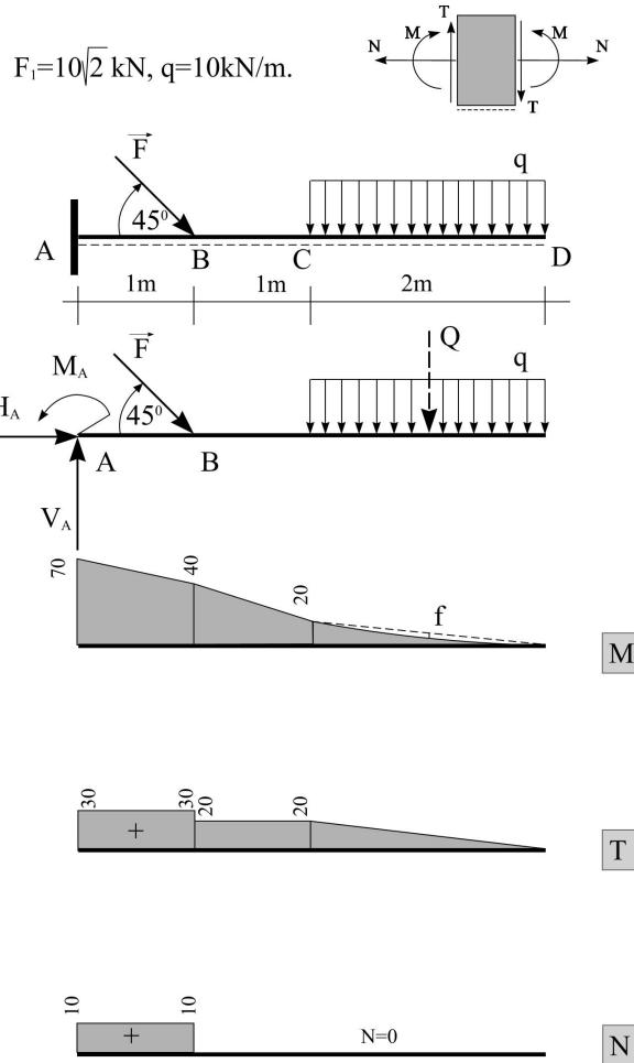
Konzolni nosač je opterećen koncentrisanom silom i kontinualnim opterećenjem čija je rezultanta:  $Q=q \cdot l=10 \cdot 2=20 \text{ kN}$ .
