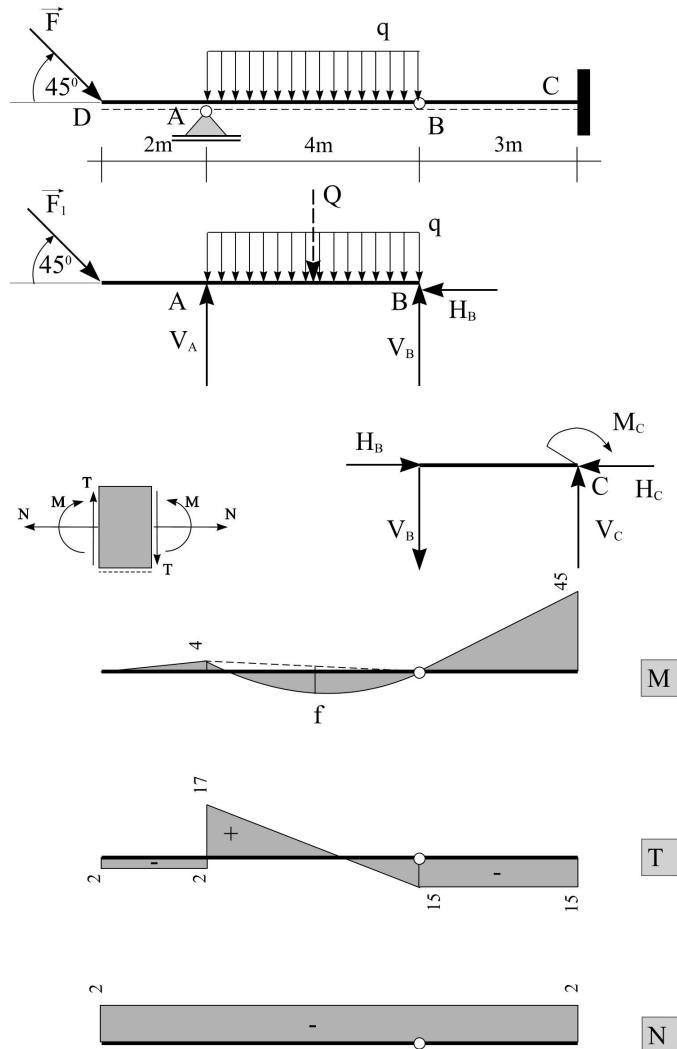
Gerberov nosač prikazan na slici je na desnom kraju uklješten. Da bi se odredile reakcije unutrašnjih i spoljašnjih veza treba se oslobođiti veza čime se vrši dekompozicija sistema na dva tela.
