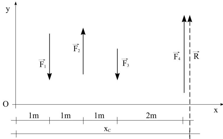
Rezultanta sistema paralelnih sila je paralelna sa silama sistema, a njen intenzitet je jednak algebarskom zbiru sila:
