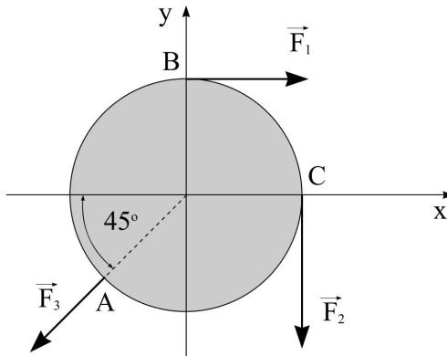
Sa slike je očigledno da se napadne linije sila seku u jednoj tački. Sila  $F_1$  je pod uglom  $\alpha_1=0^\circ$  u odnosu na osu Ox, sila  $F_2$  je pod uglom  $\alpha_2=270^\circ$ , a sila  $F_3$  pod uglom  $\alpha_3=225^\circ$ , tako da su projekcije sila sistema na pravce osa Ox i Oy:
