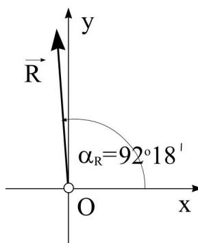
2. Odrediti veličinu i pravac rezultante datih sila koje dejstvuju na materijalnu tačku A analitičkim putem.  $F_1=3\text{kN}$ ,  $F_2=2\text{kN}$ ,  $F_3=4\text{kN}$ ,  $F_4=5\text{kN}$ .
