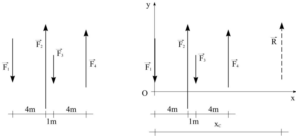
Koordinatni sistem treba postaviti tako da sile budu paralelne sa jednom od osa. Postaviće se osa y tako da se poklapa sa napadnom linijom sile  $F_1$ .
